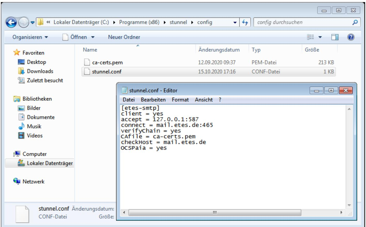
Öffnen Sie die Konfigurationsdatei `C:\Programme (x86)\stunnel\config\stunnel.conf` (32 Bit-System) bzw. `C:\Programme\stunnel\config\stunnel.conf`
